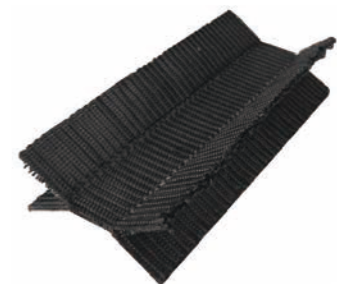
3次元プリフォームにより、このような複雑な形状でも製作可能になる。
