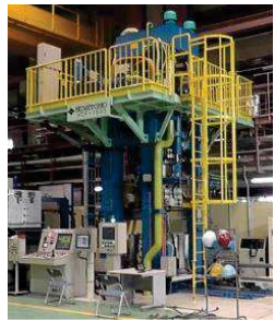
1,500トン鍛造シミュレータ (NIMSに設置)
